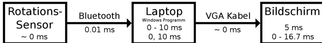
Abbildung 13: Blockdiagramm zur Latenz der DVA Apparatur
