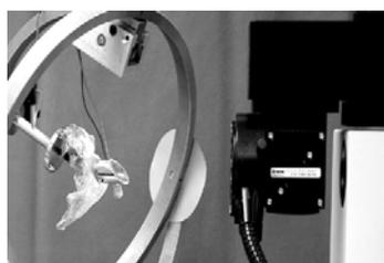
**Bild 1:** Messeinrichtung für die Untersuchung der Trommelfellmembran: das Felsenbein ist auf einem Repositionierungssystem fixiert (links), das TM wird mit dem SLDV (rechts) gemessen
