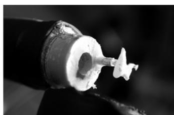
**Bild 2:** Die isolierten Ossikel werden mit einem Metallstift auf einem Piezoelement fixiert. Unten ist der Zufuhrschlauch (schwarz) für den warmen und feuchten Luftstrom sichtbar.
